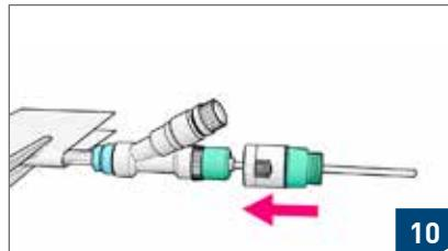
Tørk intestinalsonden med et kompress. Tre den grønn/hvite klikk-koblingen på intestinalsonden.
