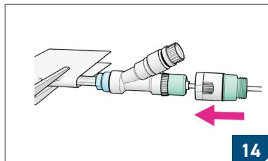
Tre den grønn/hvite klikk-koblingen på intestinalsonden. La det være et lite mellomrom mellom Y-koblingen og klikk-koblingen.
